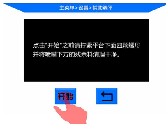
5、打印头将按顺序先后移动至平台的**四个探测点**。当打印头移动到打印平台首个探测点时，**如下图**，请**顺时针慢慢拧松**对应平台底下的螺母，直到**刚好**听到蜂鸣器响，点击“下一步”，对下一个探测点进行相同操作。（下同）。
